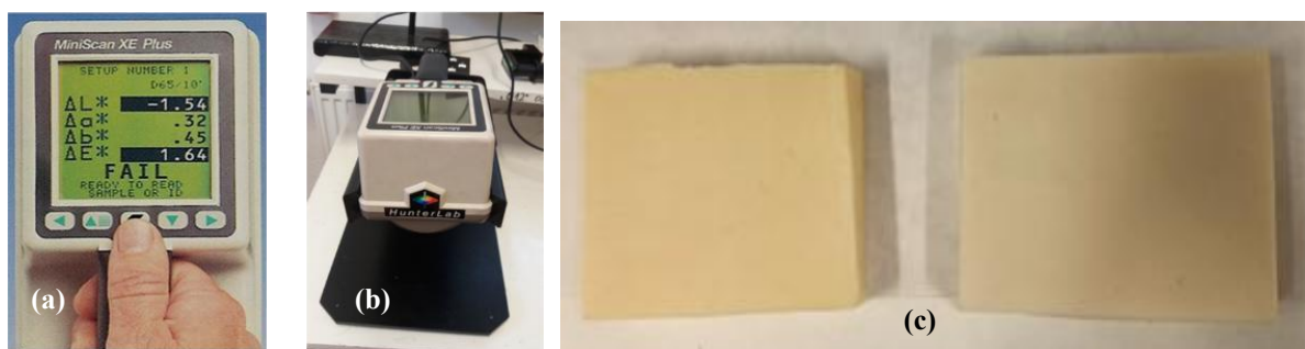
Rysunek 15. Spektrofotometr HunterLab (a,b) oraz kształt badanych próbki sera i wyrobu seropodobnego (c).
