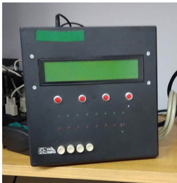
Rysunek 2.18. Fotografia monitora/konwertera sygnałów przesyłanych łączami szeregowymi
