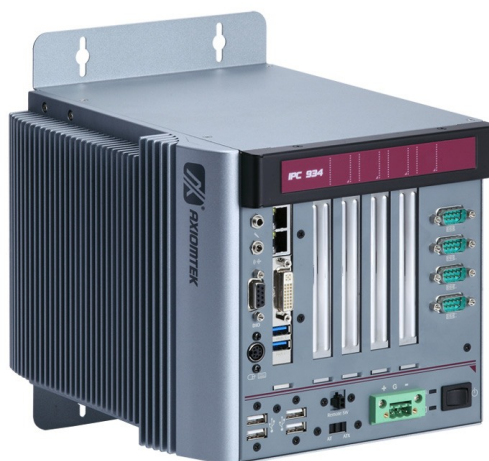
Rysunek 2.17. Zdjęcie sterownika SLRT Target – komputera przemysłowego Axiomtek IPC934-230-FL [15]
