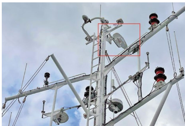
Antenę kompasu satelitarnego umieszczono wysoko na maszcie dla uniknięcia zakłóceń i kątów martwych
