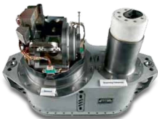
Sekstant i teleskop skaningowy Apollo (opracowany w 1960 roku przez Kollsman Instrument Company, USA)
